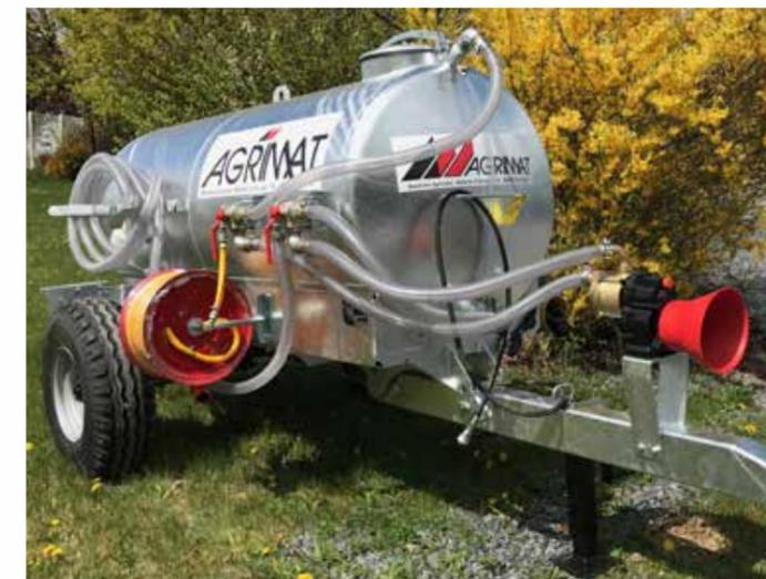
Tonne à eau monocoque avec pompe à cordon et enrouleur
